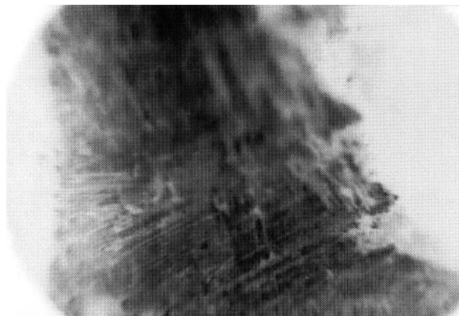
Рисунок 4.3 – Наволочування металу у бік зсуву на плунжері (Результат незадовільної підготовки зразка-плунжера перед випробуванням)x 125 (дані не враховувались)
