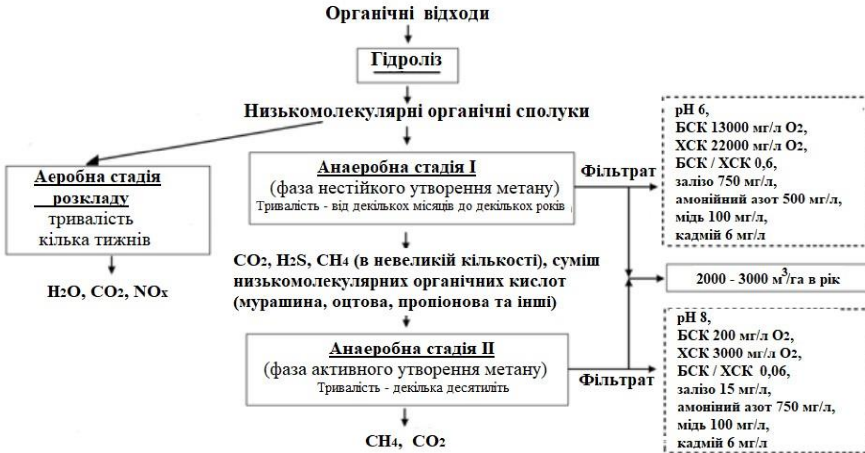
Рисунок 3.5 – Загальні процеси розкладання органічних сполук при захороненню ТПВ на полігоні (основні стадії розкладу, склад утворених продуктів і фільтрату)
