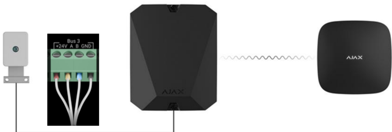
Рис. 3.3 – Схема підключення приладів сторонніх виробників до системи Ajax за допомогою пристрою MultiTransmitter Jeweller.
