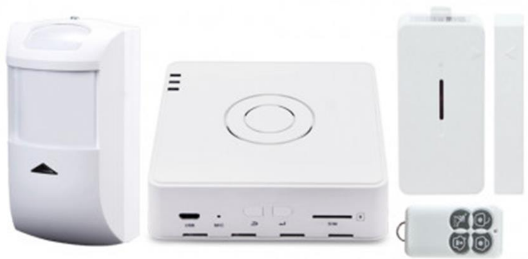
Рис. 2.10 – Бездротова Wi-Fi система безпеки S2 Broadlink [18].
