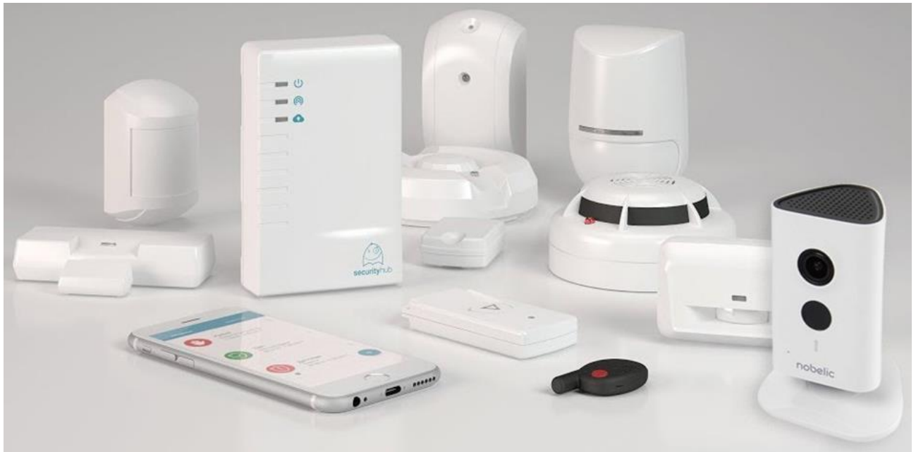
Рис. 2.1 - Елементи та пристрої систем автоматизації житла [8].
