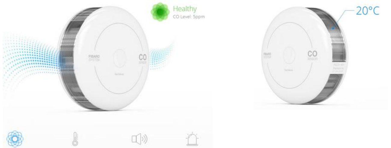
Рис. 2.6 - Бездротовий інтегрований сенсор CO системи FIBARO [15].
