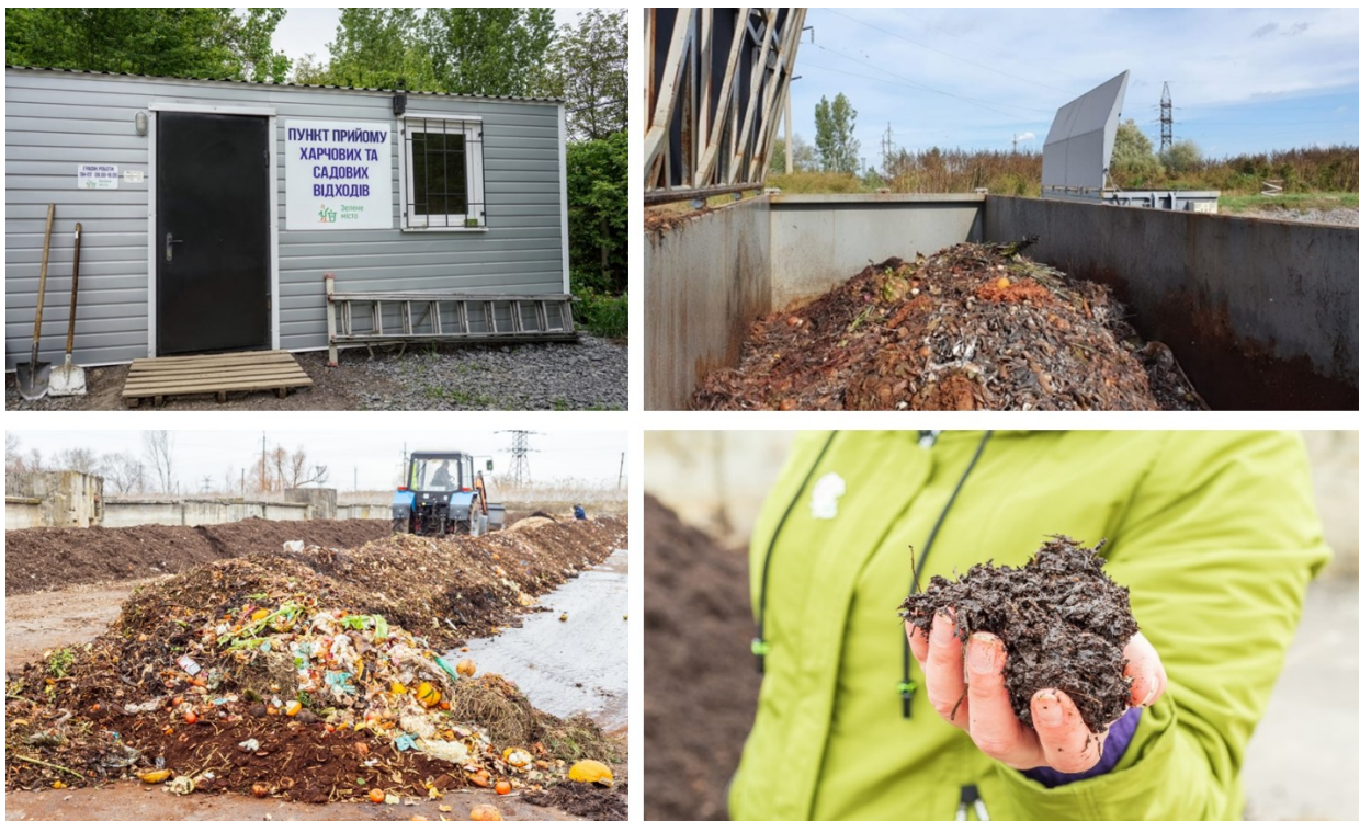
Рисунок 3.4 – Компостування органічної фракції ТПВ на міській станції
