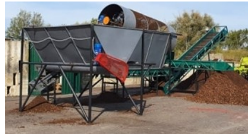
г) просіювання готового компосту для відокремлення грубої фракції
