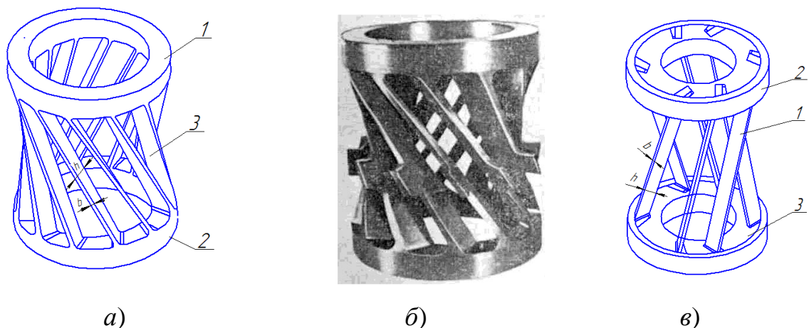
Рис. 1.4. Ґратчастий гіперболоїдний торсіон: а) – монолітна конструкція; б) – виробничий взірець з виступами; в) – складальна набірна конструкція
