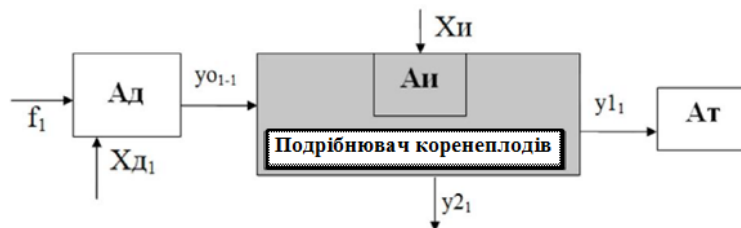
Рис. Структурна схема функціонування лінії подрібнення коренеплодів кормового буряка: Ад-пристрої для дозування; Ап-подрібнювач коренеплодів; Ат-пристрій транспортування; f_1 , – узагальнені статистичні показники, що характеризують корми, які надходять на подрібнення, їхні фізико-механічні властивості; X_{d1} - узагальнені значення внутрішніх факторів дозуючого пристрою; X_{п} – узагальнені значення внутрішніх факторів подрібнювача; u_{01-1} – маса коренеплодів, що надходить на подрібнення; u_{11} – подрібнена маса (продуктивність подрібнювача); u_{21} – маса рідкої фракції.
