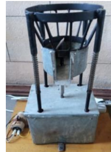
Рис. Пристрій для видалення стрижнів з головок капусти
