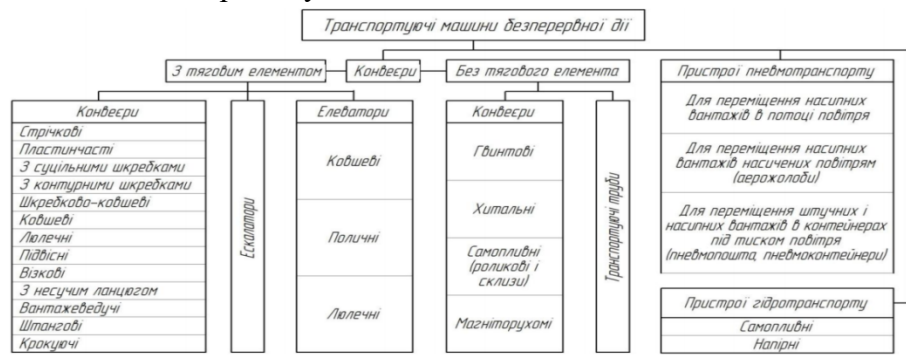
Рис. Класифікація транспортувальних машин безперервної дії
