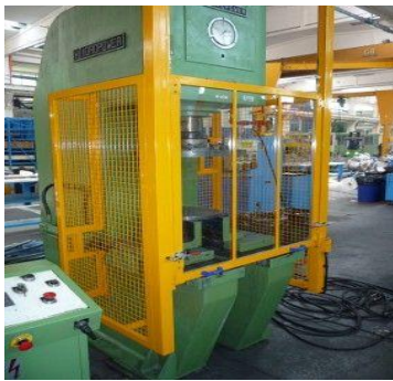
Рис. Захисний екран преса моделі FVH2.
