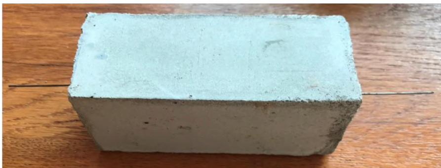
Рис. 1. Призма з фіброю, закладеною у їх торці
