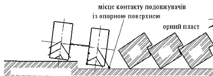
Рис. 2. Схема контакту подовжувачів коліс із опорною поверхнею
