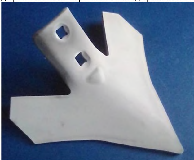
Рис. 2. Зовнішній вигляд лапи культиватора, модифікованої азотуванням у тліючому розряді
