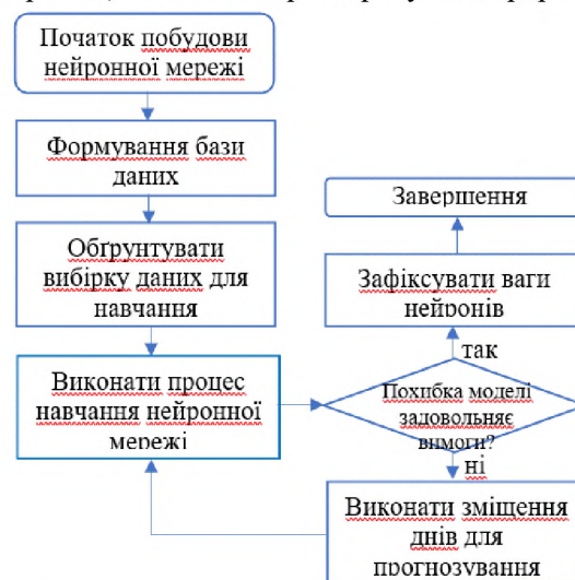
Рис. 1. Укрупнений алгоритм навчання нейронної мережі для прогнозування дозволеного часу виконання робіт упродовж окремих діб життєвого циклу гібридних проєктів
