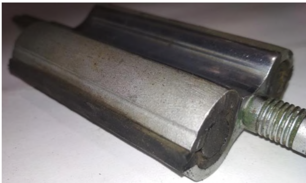
Рис. 2. Загальний вигляд роторів вакуумної помпи
