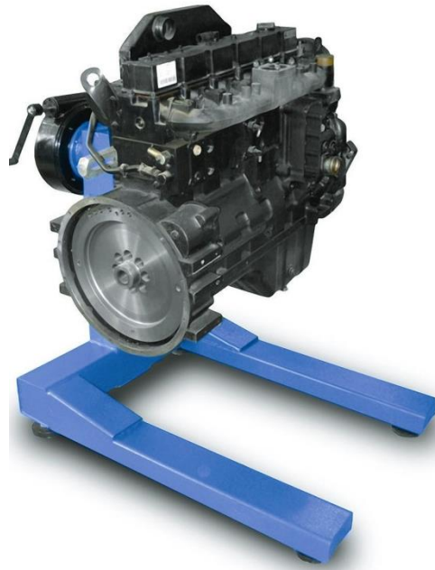
Рисунок 3.2 – Стенд універсальний для розбирання-складання двигунів P1250
