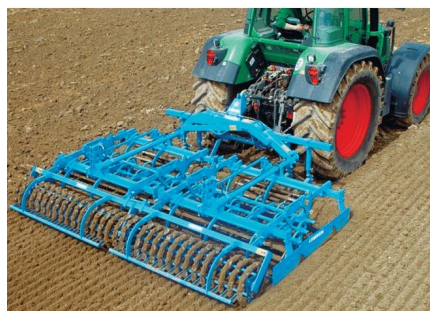
Рис.1.11. Використання агрегату для передпосівного обробітку ґрунту типу System-Компактор фірми Lemke
