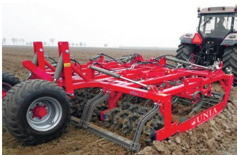
Рис. 1.10. Передпосівний обробіток ґрунту важкими напівначіпними агрегатами іноземного виробництва
