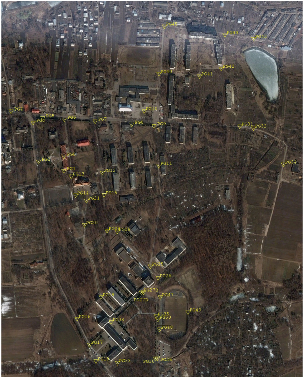
Рисунок 12 — Опорна знімальна геодезична мережа на території ЛНУП
