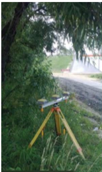
Рисунок 3.1 Згущення геодезичної мережі методом GNSS
