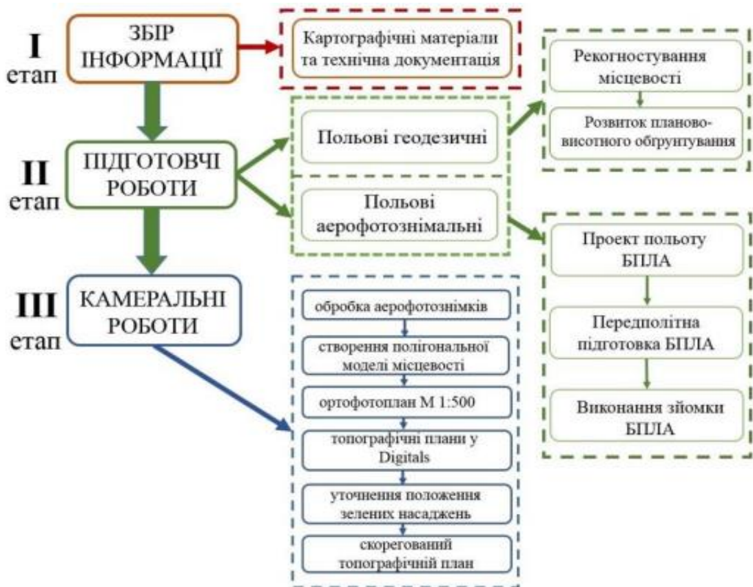
Рисунок 2.3 Етапи проведення аерознімання з використанням БПЛА
