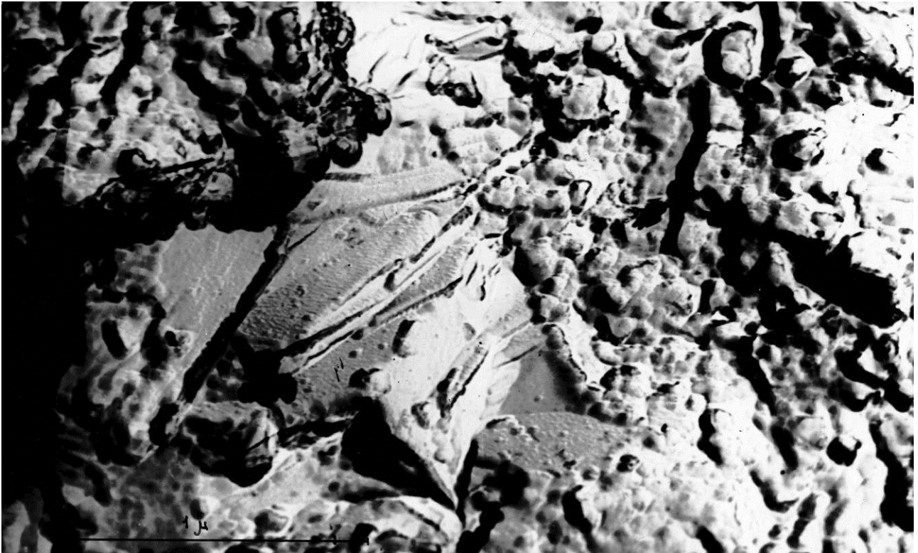
Рис. 3.67. Мікрофотографія репліки зі сколу портландцементного каменю №3, який твердів один рік.
