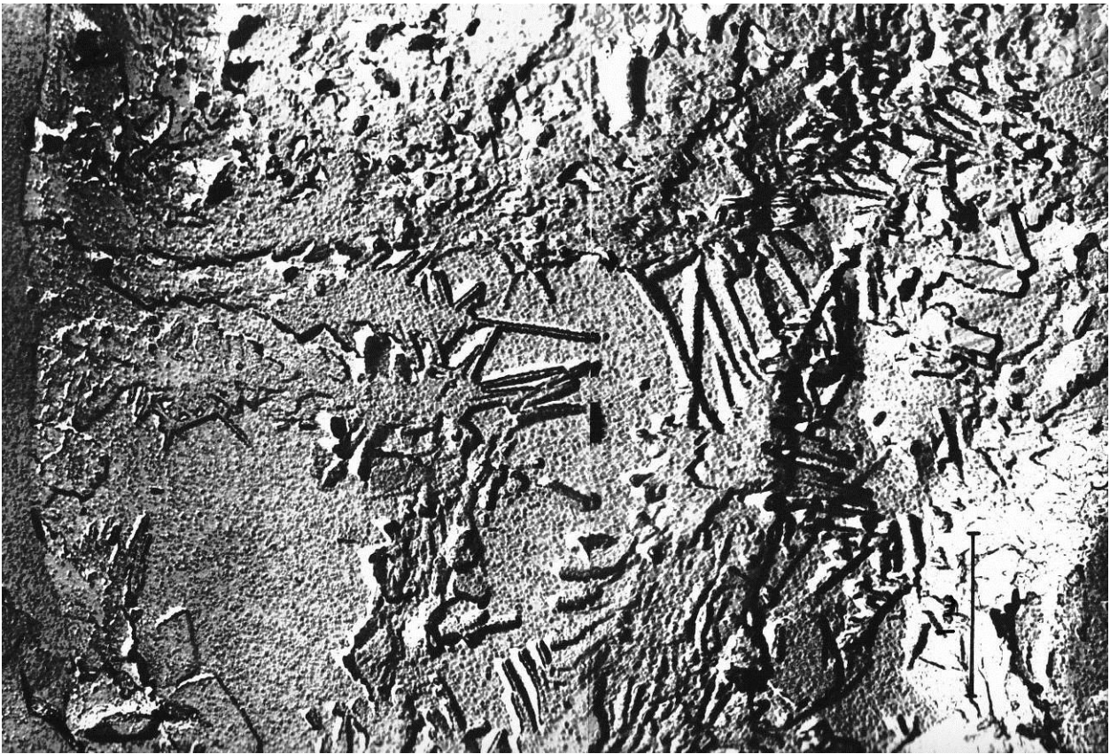
Рис. 3.43. Мікрофотографія репліки з поверхні клінкеру портландцементу №1, гідратованого у воді одну годину.
