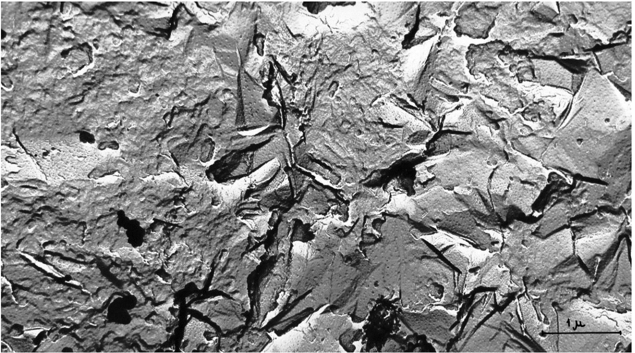
Рис. 3.32. Мікрофотографія репліки з поверхні C_2S , яка знаходилася у воді 24 години.
