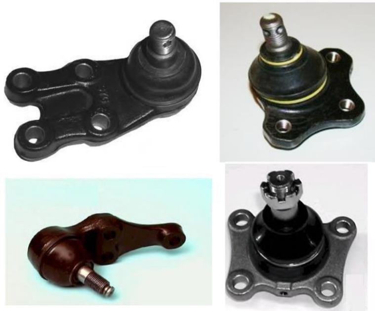
Рисунок 1.3 – Різні варіанти конструкцій кульових шарнірів використовуваних у підвісках автомобілів
