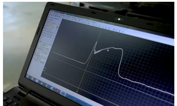
Рисунок 3.4 – Осцилограми зміни показів кількості повітря, під час перегазовки та вихідна напруга 3,1 В.
