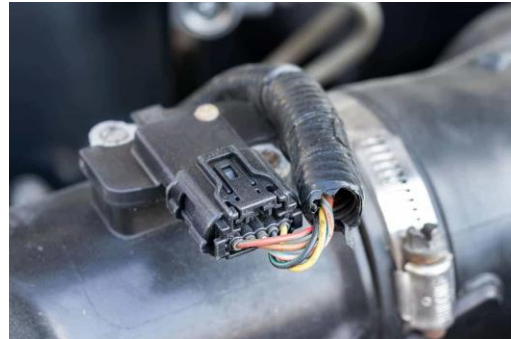
Рисунок 3.6 – Неякісна герметизація електропроводників.
