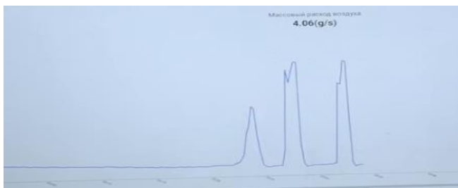
Рисунок 3.4 – Осцилограми зміни показів кількості повітря, під час перегазовки та вихідна напруга 3,1 В.
