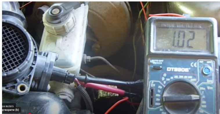
Рисунок 3.2 – Визначення вихідного сигналу ДМВП (за увімкненого запалювання)
