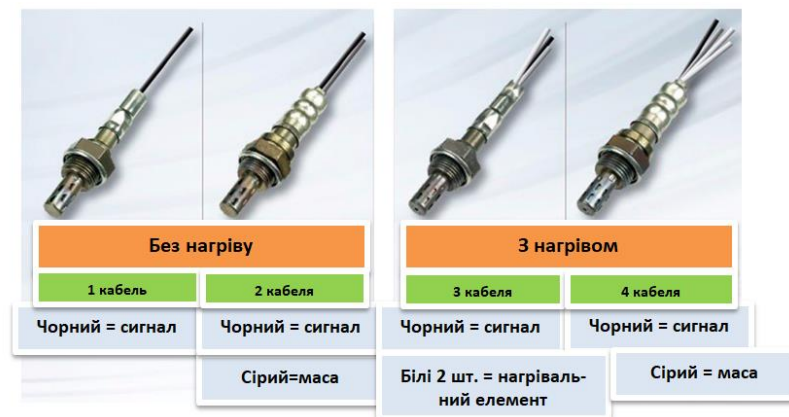
Рисунок 1.3 – Особливості конструкції сенсорів кисню [19].
