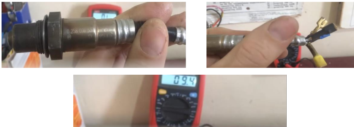
Рисунок 3.1 – Визначення опору нагрівального елементу сенсора кисню
