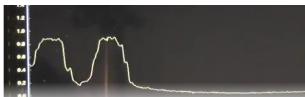
Рисунок 3.6 – Осцилограми вихідних сигналів датчика кисню.
