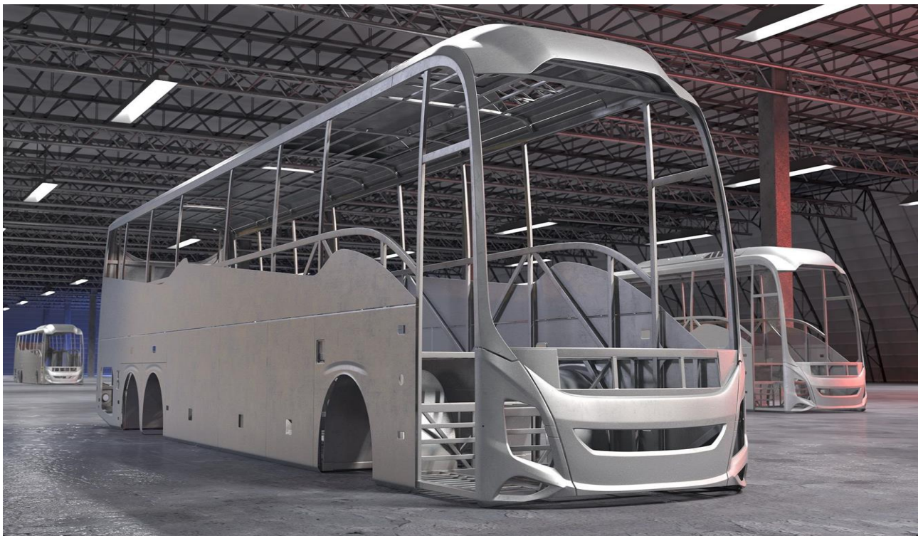
Рисунок 1.2. Каркас кузова автобуса з зовнішнім облицюванням.
