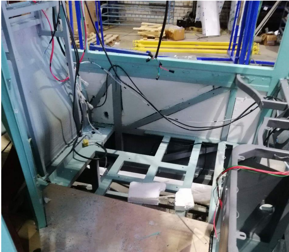
Рисунок 2.2. Утеплення боковини кузова автобуса пінопластом (ПСБ).
