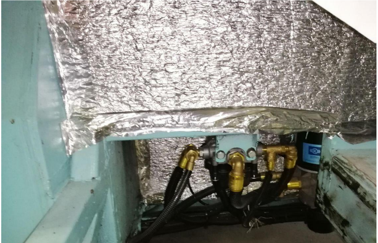
Рисунок 2.3. Термо-шумоізоляція мотовідсіку автобуса.
