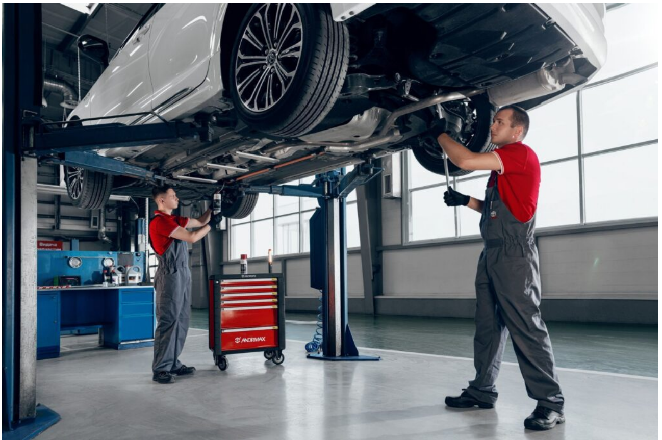
Рисунок 1.2. Діагностика ходової частини автомобіля.
