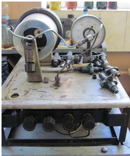
Рисунок 3.1 – Прилад КИ-3333 для випробування і регулювання форсунок
