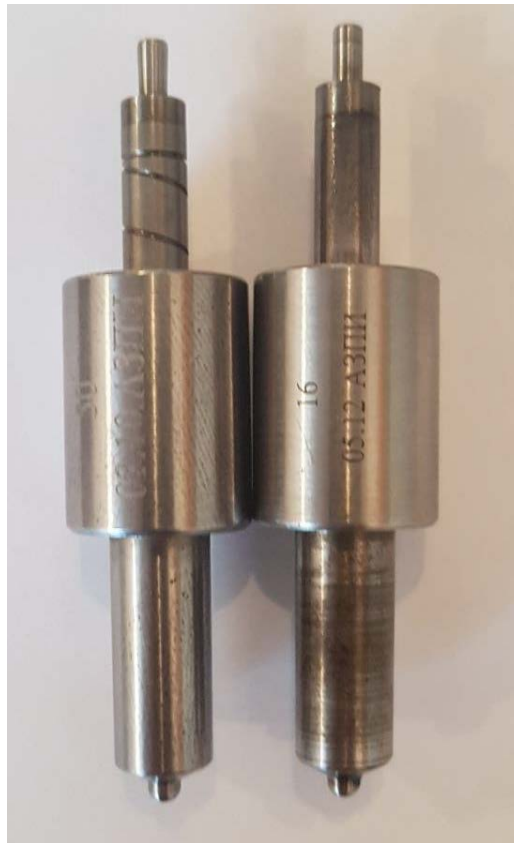
Рисунок 4.1 – Розпилювачі дизельної форсунки ФД-22 з модернізованою і серійною голками
