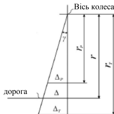
Рисунок 2.2 Схема зміни радіусу кочення колеса під час розгону, рівномірного руху та гальмування [7]
