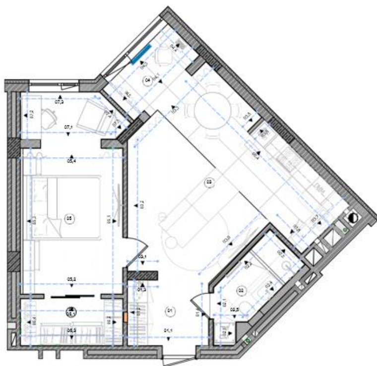
Рис. 6 План маркування розгортки
