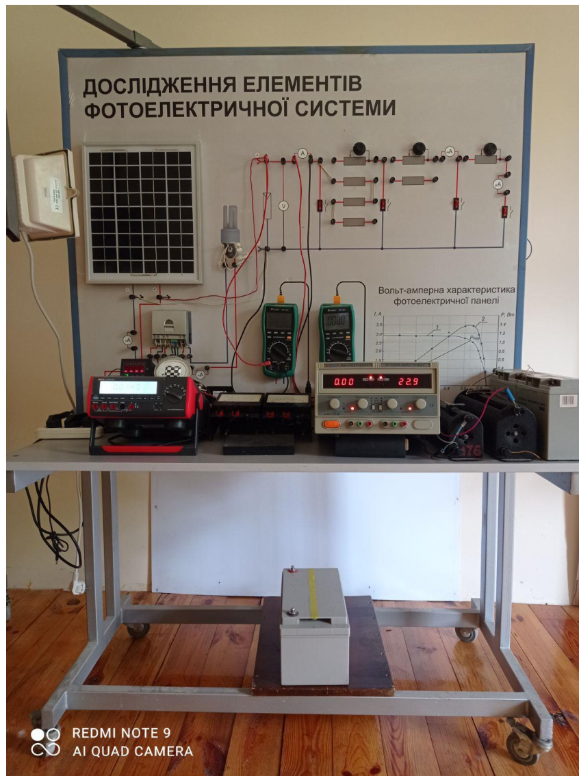
Рисунок 3.3 Загальний вигляд лабораторного станда з додатковими засобами для вимірювання темнових струмів
