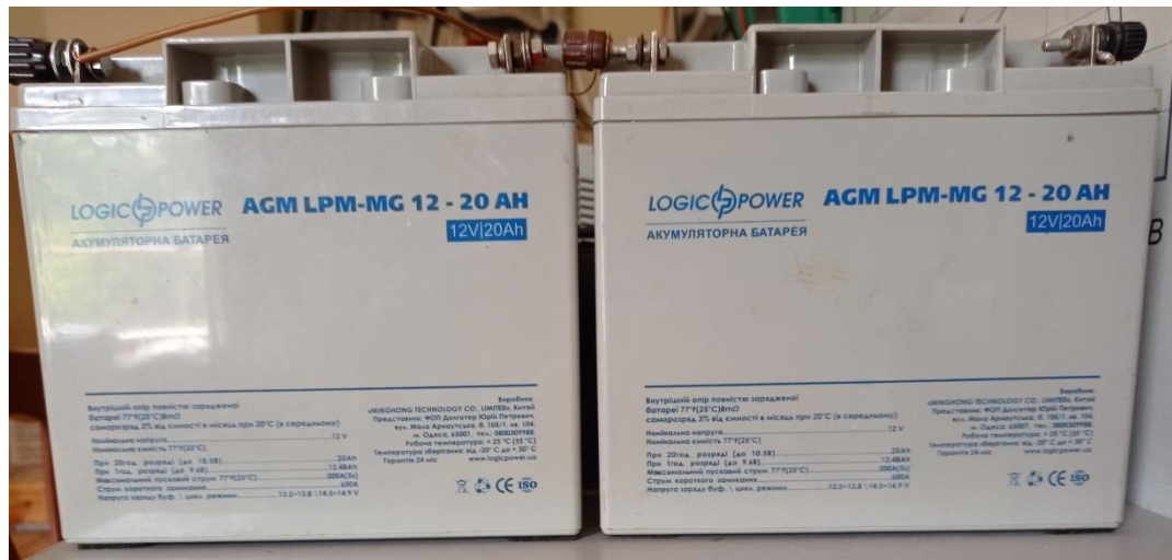
Рисунок 3.1. Батарея з двох акумуляторів для прикладання зовнішньої напруги до фотомодуля
