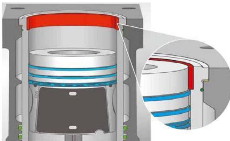
Рисунок 1.3. Гільза циліндра з вогневою кільцем-вставкою фірми KOLBENSCHMIDT
