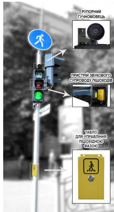
Рисунок 2.5 – Пристрій звукового оповіщення на регульованому переході
