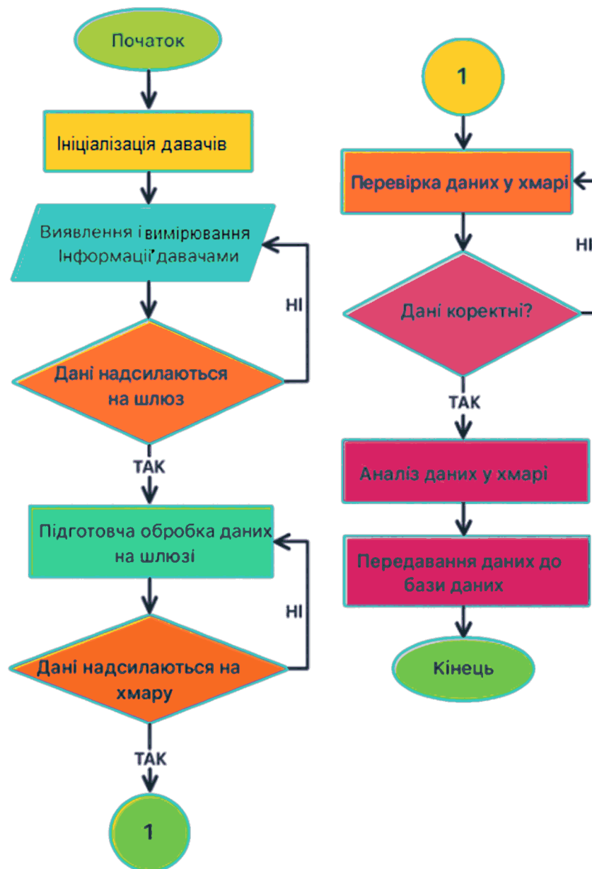
Рисунок 2.2 – Блок-схема хмарного сервісу збору та обробки сенсорних даних
