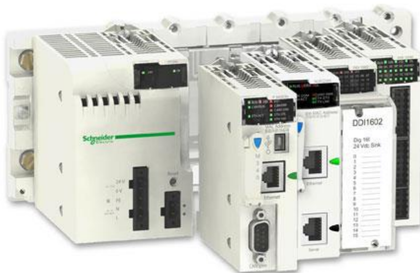
Рис. 2.2. Загальний вигляд мікропроцесорного контролера фірми Schneider Electric типу Modicon M340
