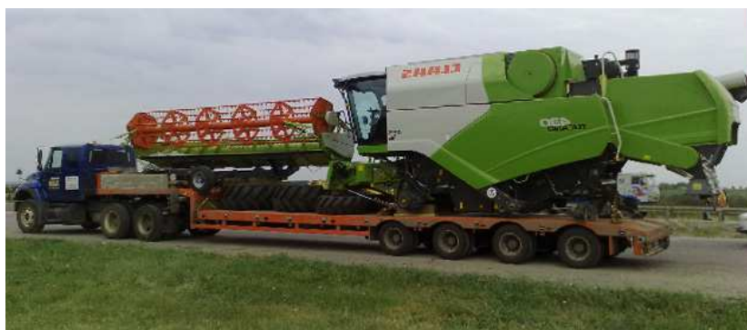
Рисунок 2.6 – Перевезення комбайна на низькорамному тралі-напівпричепі
