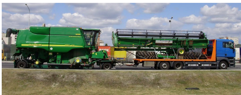
Рисунок 2.5 – Перевезення комбайна Джон Дір на триланковому автопоїзді
