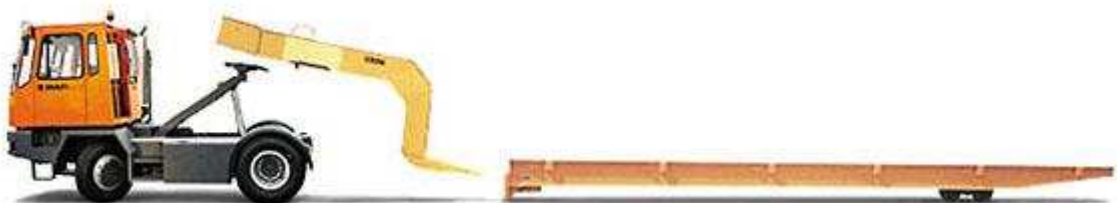
Рисунок 1.1 – Використання гузника для зчіплення тягача з низькорамним тралом
