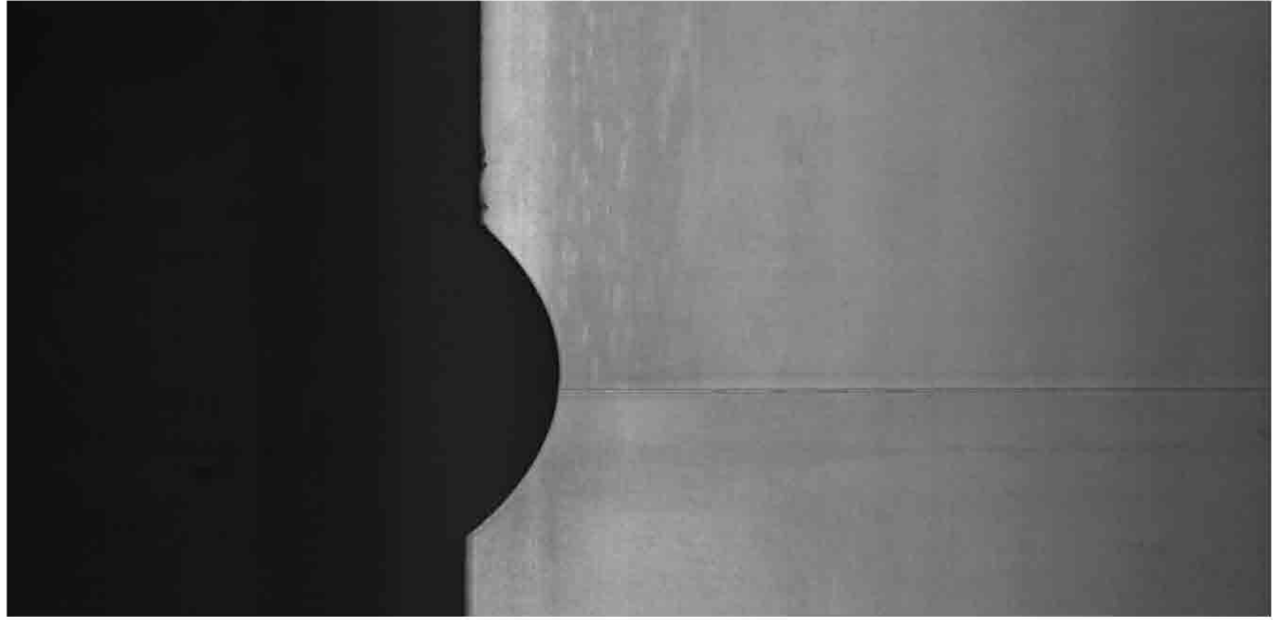
Рисунок 2.5 Дефекти геометрії після зварювання
