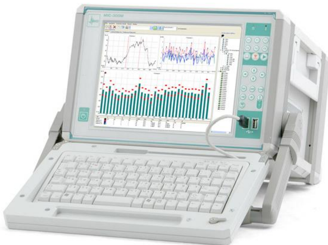
Рисунок 2. 6 - Вимірювальний комплекс моніторингу та контролю генерації та споживання електроенергії в розумній енергомережі.
