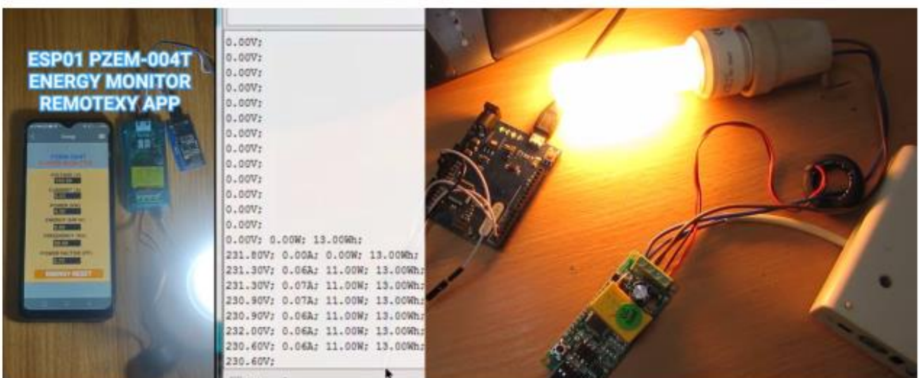
Рисунок 3.5. Прототип розробленої системи моніторингу та тарифікації електроенергії в режимі реального часу
