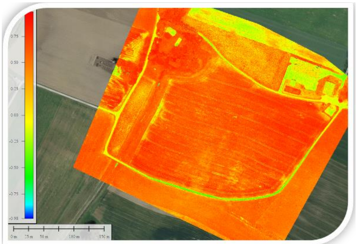
Рис. 1.4. Гіперспектральне знімання захоплює довжини хвиль від 250 до 15 000 нм і теплове інфрачервоне вимірювання
