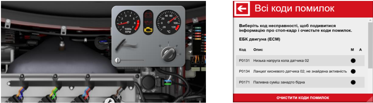
Рисунок 3.4 – Режим прогрівання двигуна з точковою подачею палива та появу кодів помилок.
