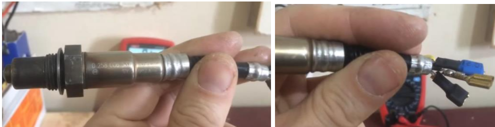
Рисунок 1.2 – Загальний вигляд сенсора кисню.
