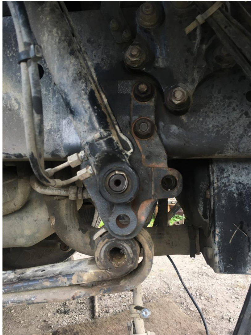
Рисунок 3.2 – Задня ресорна підвіска вантажного автомобіля DAF XF 95
