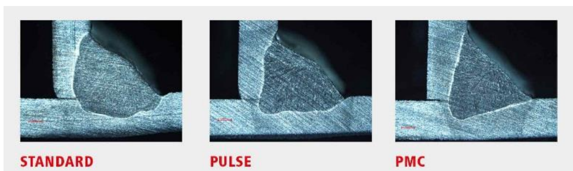
Рисунок 3.9 – Перерізи зварних швів
