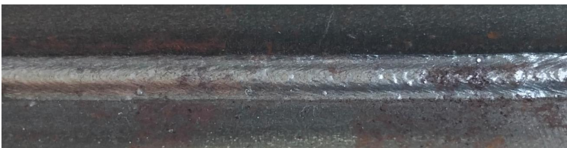
Рисунок 3.8 – Зразки зварних з'єднань, виконаних способом кутом вперед (а) та кутом назад (б)
