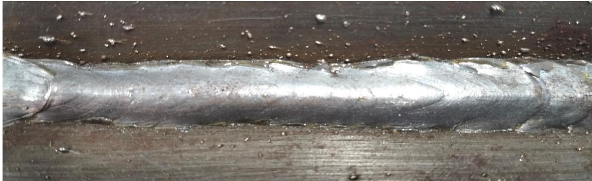
Рисунок 3.9 – Кутові зварні шви, виконані при корекції довжини дуги -15 (а) та +15 (б)
