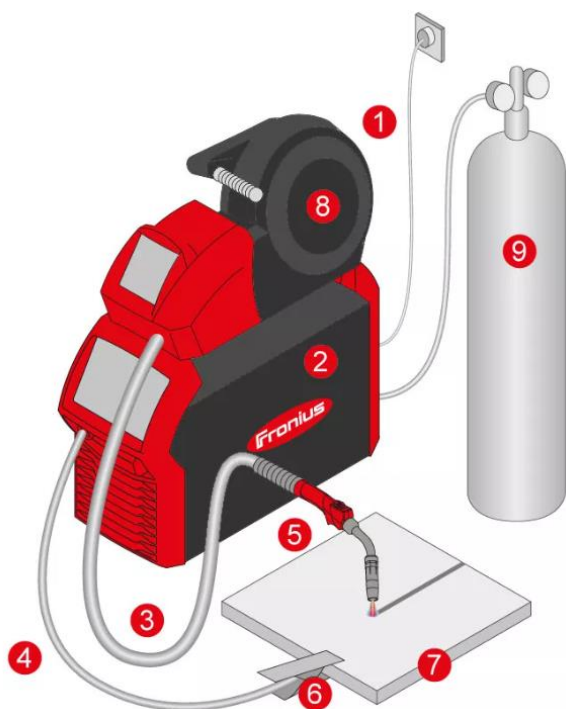
Рисунок 1.6 - Зварювальний апарат для ручного MIG/MAG зварювання 1 - підключення до електромережі; 2 - джерело живлення; 3 - шланговий пакет; 4 - кабель заземлення; 5 - зварювальний пальник; 6 - клемма заземлення; 7 - деталь; 8 - присадний матеріал; 9 - захисний газ
