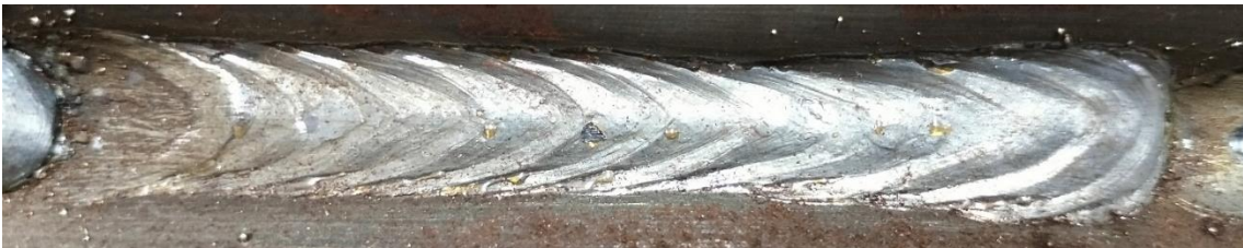
Рисунок 3.10 – Зварні шви, виконані на різній динаміці дуги
