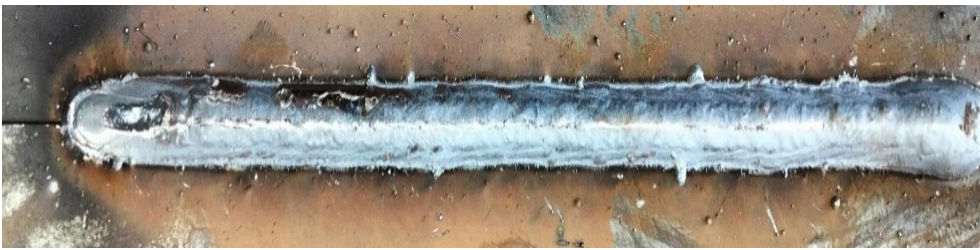
Рисунок 3.6 – Зразки стикових зварних швів
