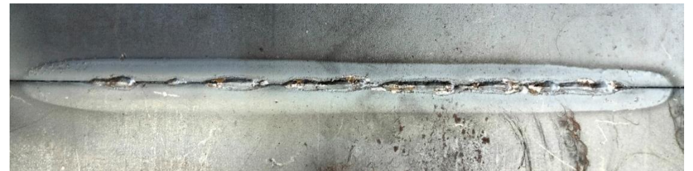
Рисунок 3.6 – Зразки стикових зварних швів
