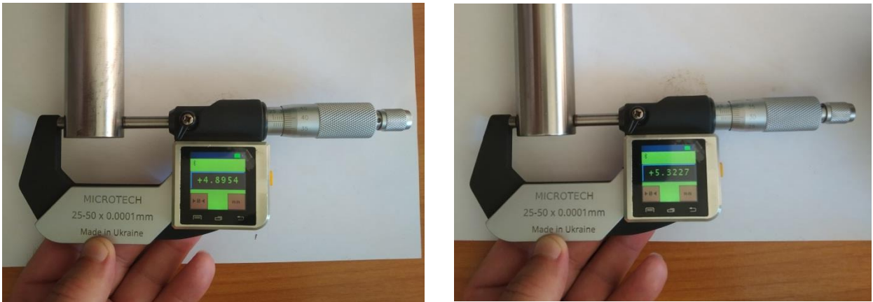
Рисунок 3.8 – Схема перевірки розмірів конусної оправки.
