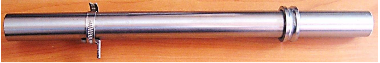
Рисунок 3.10 – Загальний вигляд конусної оправки з внутрішнім кільцем підшипника і закріпленим упором
