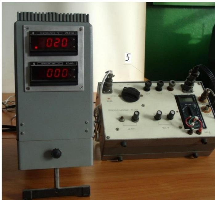
Рисунок 3.3 – АЦП та підсилювач цифрового сигналу: 5 – АЦП тензопідсилювача
