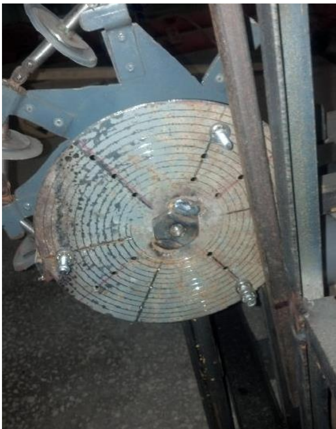
Рис. 3.2 - Привідний обертовий диск процесу сепарації та транспортування сипких матеріалів
