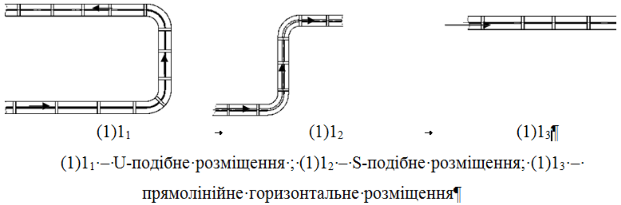
Рис. 2.2 - Приклади компоновки механізмів транспортування матеріалу
