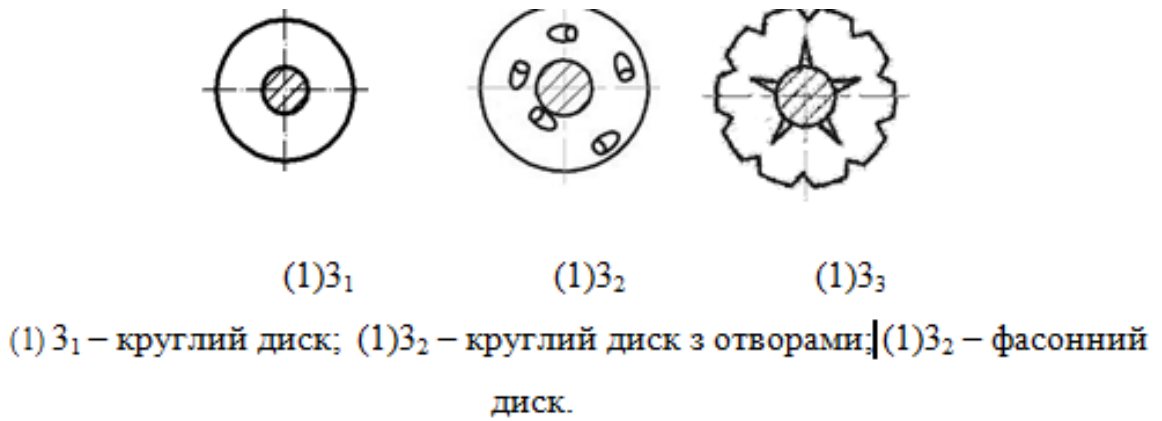
Рис. 2.4. Приклади компоновки конструкцій подавальних дисків
