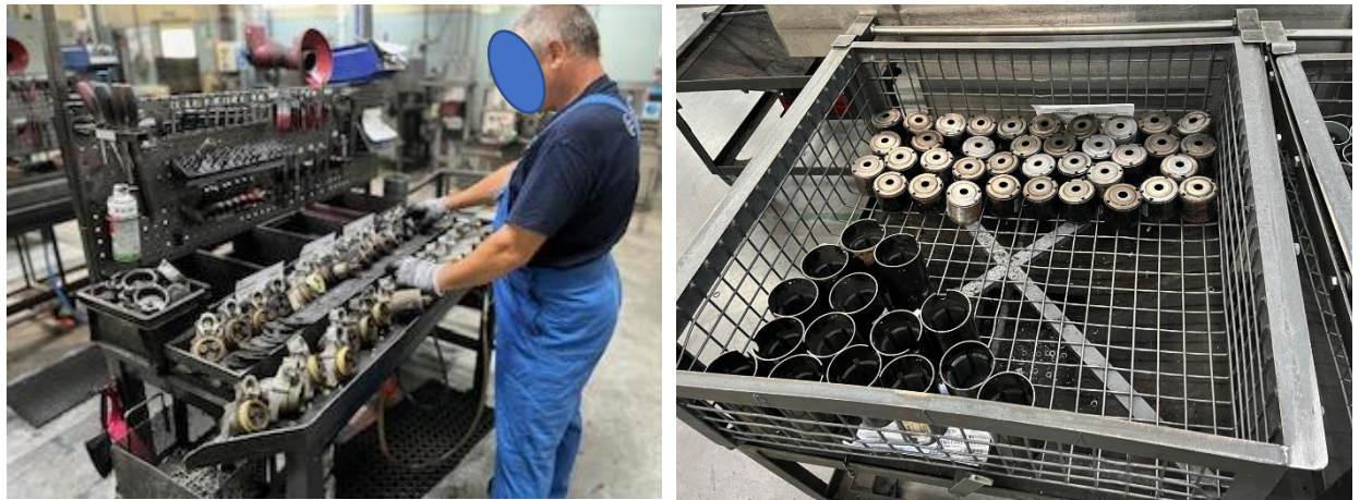
Рисунок 1.6 – Процеси розбирання (а) та сортування деталей стартера за типом (б)
