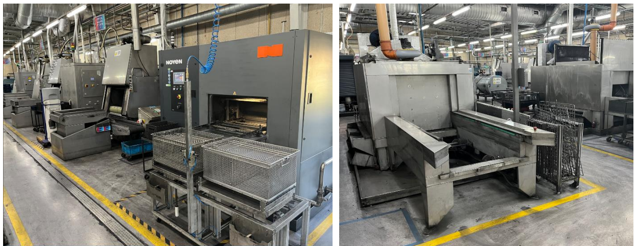
Рисунок 1.7 – Мийні машини в ДП “Роберт Бош Продакшн Україна” для миття не електричних (а) та електричних складових (б) стартера
