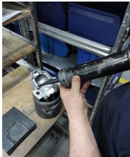
Рисунок 4.4 – Фрагмент технологічної операції нанесення силікону на кришку стартера в ручну в умовах ДП “Роберт Бош Продакшн Україна”
