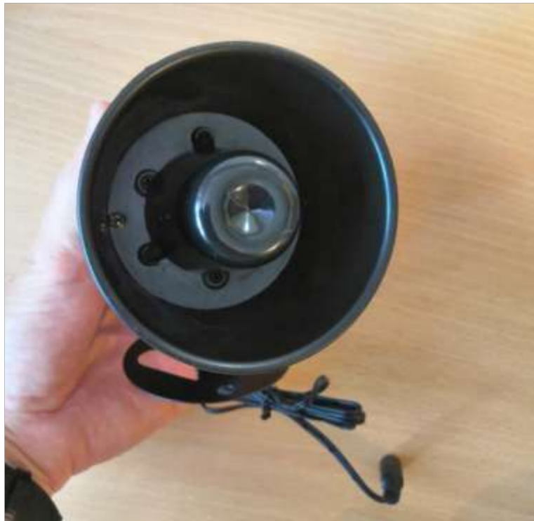
Рисунок 5.2 – Біоакустичний пристрій відлякування птахів
