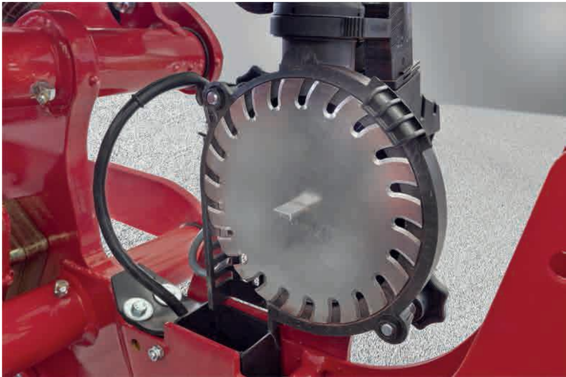
Рисунок 3.12 – Налаштування дозатора насіння сівалки HORSCH Maestro для висіву кукурудзи:
