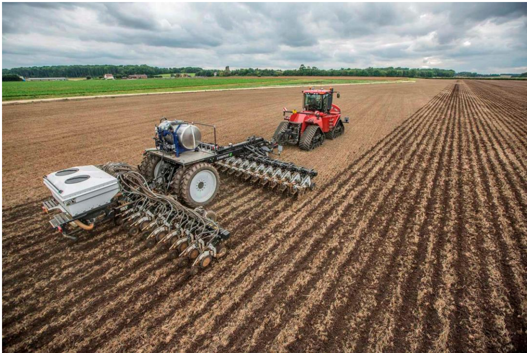
Рисунок 1.4 - Обробіток ґрунту за технологією Strip till
