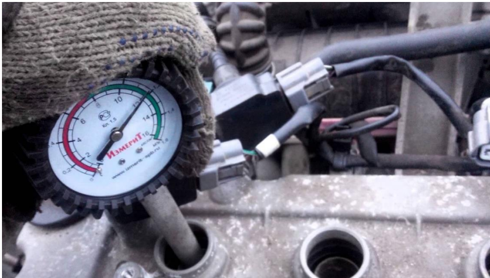
Рисунок 3.1 – Вимірювання рівня компресії за допомогою компрессометра
