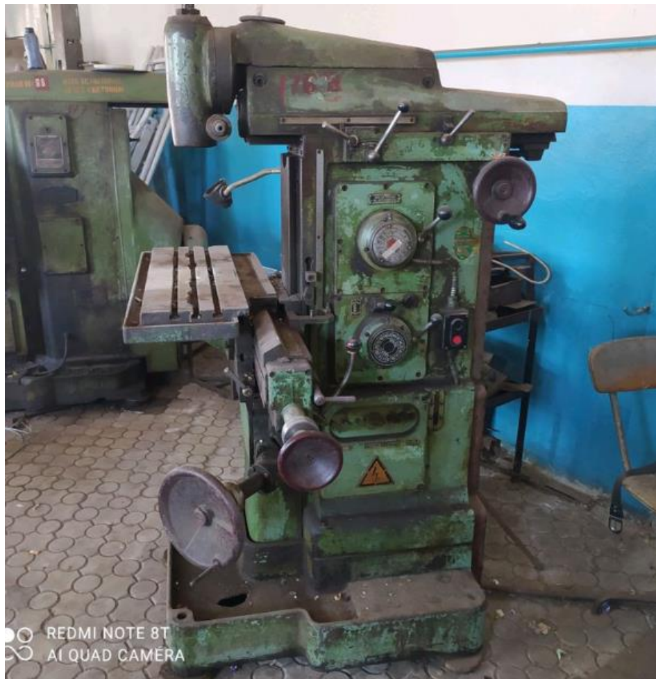
Рис. 3.2. Верстат фрезерний універсальний верстат 675;
