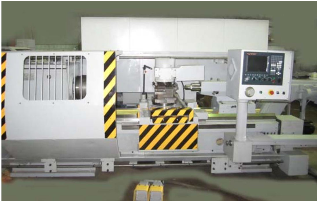
Рис. 3.1. 16К30Ф3 Верстат токарний патронно-центровий з числовим програмним управлінням (ЧПУ). Призначення, сфера застосування
