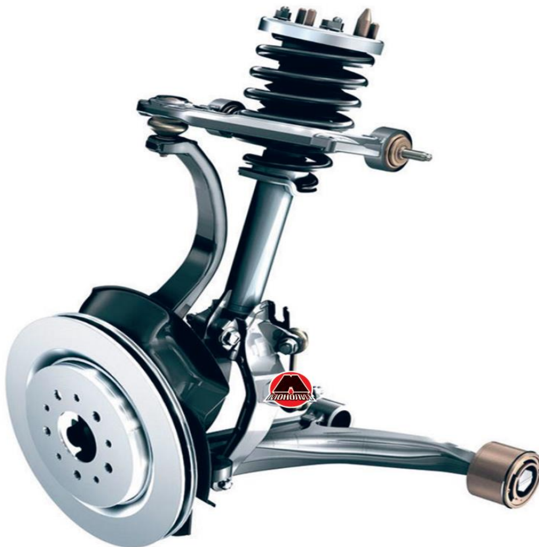
Рисунок.1.5 Передня підвіска на двох поперечних важелях з амортизаційною стійкою.
