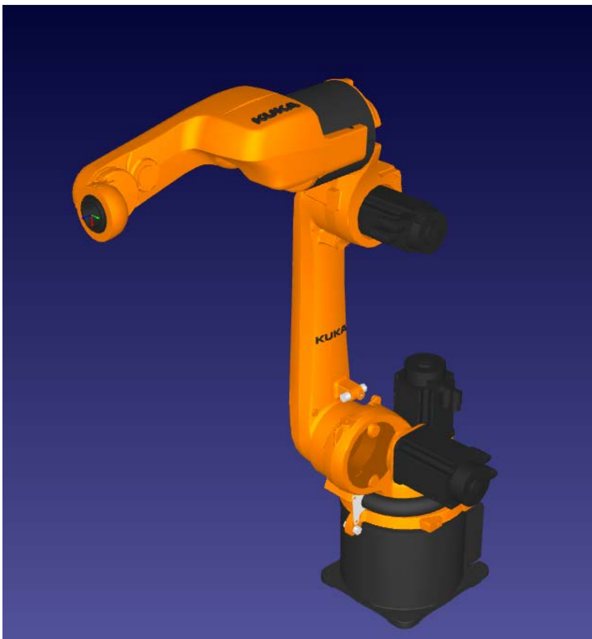
Рисунок 2.3 KUKA KR 8 R1420 arc HW - це 6-осьовий робот-маніпулятор, що використовували для складання рами
