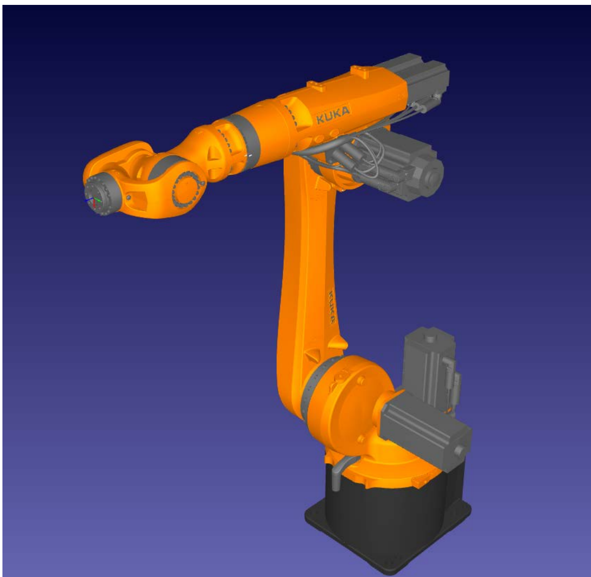
Рисунок 2.4 Робот KUKA KR 16 R1610 - 6-осьовий маніпулятор, що використовували для зварювання рами
