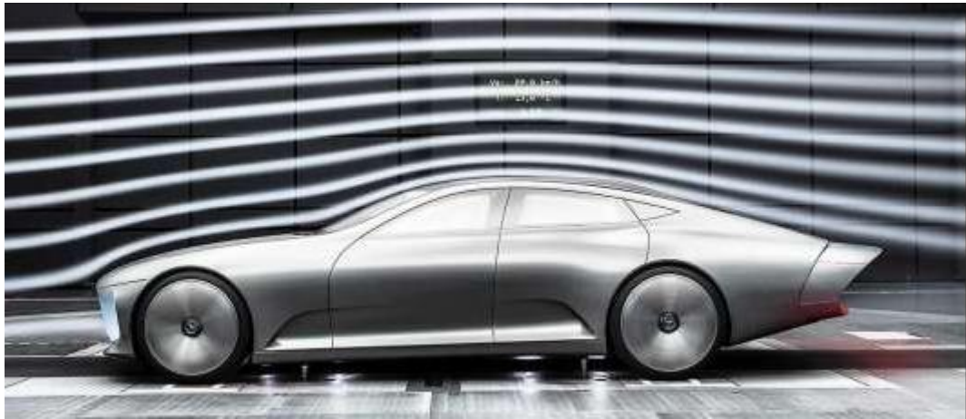
Рисунок 1.1 – Практичні випробування в аеродинамічній трубі
