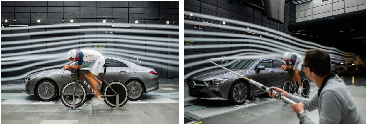
Рисунок 1.14 — Практичні випробування в аеродинамічній трубі Mercedes-Benz CLA Coupe 2019
