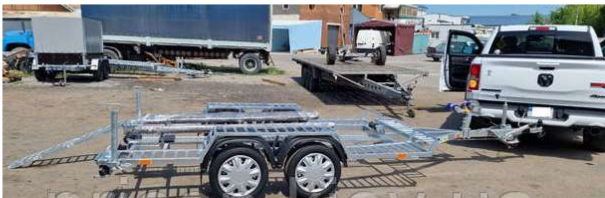
Рис. 1.3 - Причеп (лафет) двоосний для перевезення автомобілів
