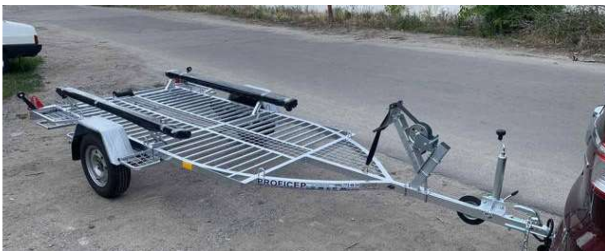
Рис. 1.5 - Причеп (лафет) одноосний для перевезення водної техніки
