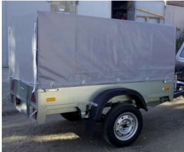
Рис. 1.8 - Причеп одноосний загального призначення, тентований
