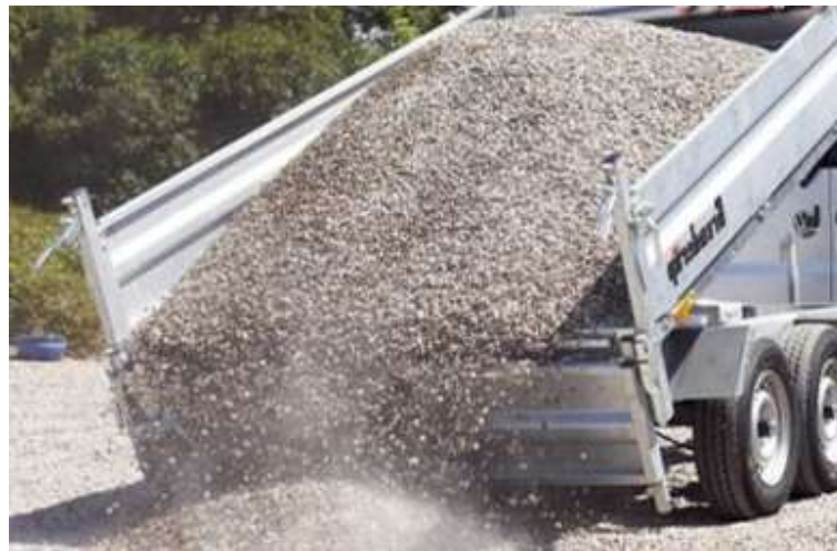
Рис. 1.16 - Прицеп-самоскид двоосний для легкового автомобіля з пристроєм для вивантаження в роботі
