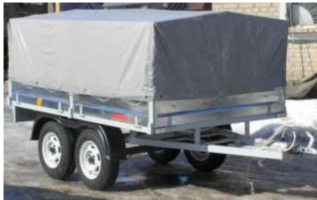
Рис. 1.9 - Причеп двоосний загального призначення, тентований
