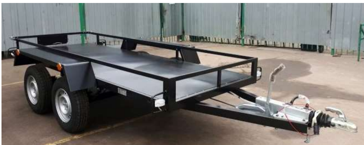
Рис. 1.4 - Причеп-платформа двоосний ЛЕВ-Л-300-14
