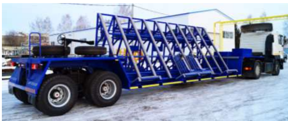
Рис. 1.1 - Причеп автомобільний, спеціальний для перевезення панелей
