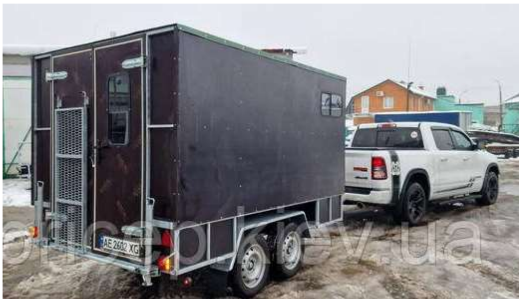
Рис. 1.7 - Причеп двоосний загального призначення з текстолітовою будкою
