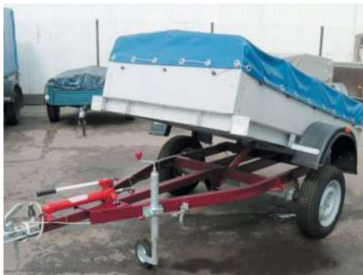
Рис. 1.13 - Причеп-самоскид тентований одноосний з ручним приводом гідравлічного перекидача
