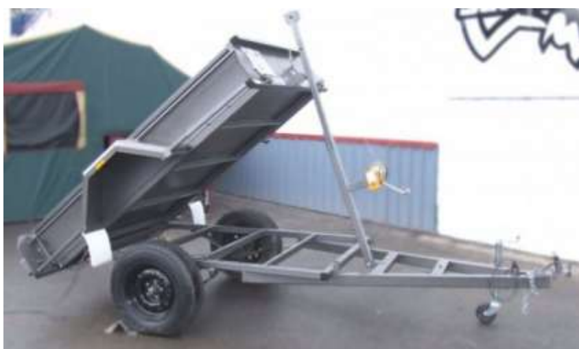
Рис. 1.14 - Причеп-самоскид одноосний з пристроєм (лебідкою) для перекидання
