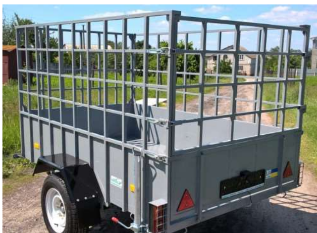
Рис. 1.2 - Причеп автомобільний, спеціальний для перевезення тварин
