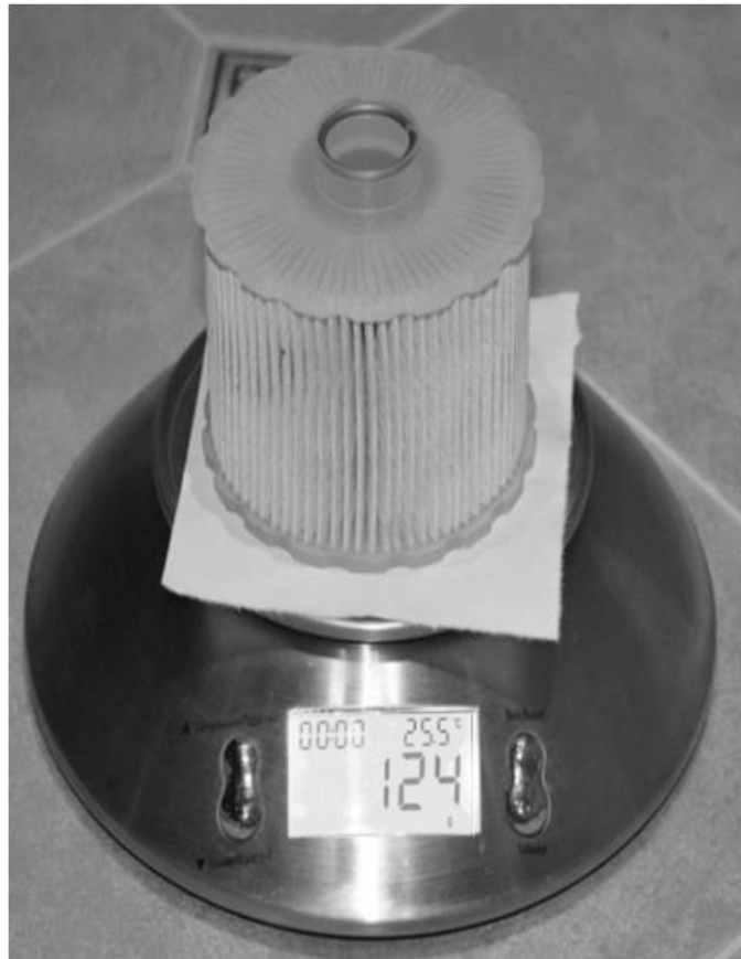
Рисунок 3.10 - Маса нового фільтра після заповнення паливом і подальшої просушки
