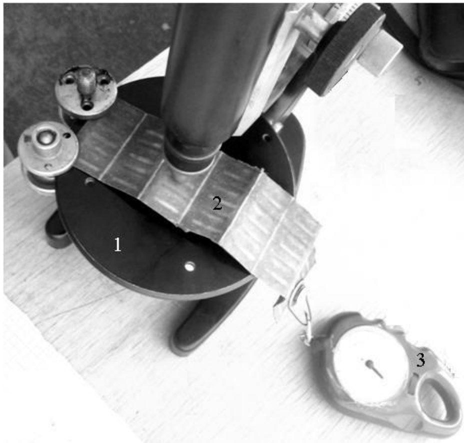
Рисунок 3.6 – Установка для вимірювання коефіцієнта пружності мембрани фільтрів: 1 - мікроскоп; 2 - мембрана фільтра, закріплена на столі мікроскопа; 3 – динамометр
