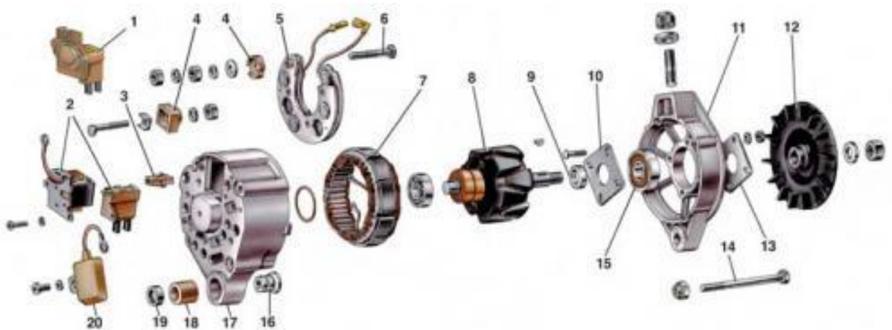
Рисунок 3.14 – розбирання генератора: 1 – регулятор напруги у зборі із щіткотримачем; 2 – регулятор напруги та щіткотримач; 3 – колодка додаткових діодів; 4 – ізолюючі втулки; 5 – випрямляючий блок; 6 – контактний болт; 7 – статор; 8 – ротор; 9 – втулка; 10 – внутрішня шайба підшипника; 11 – кришка з боку приводу; 12 – шків; 13 – зовнішня шайба кріплення підшипника; 14 – стяжний болт; 15 – передній шарикопідшипник ротора; 16 – втулка; 17 – кришка з боку контактних кілець; 18 – буферна втулка; 19 – підтискна втулка; 20 – конденсатор
