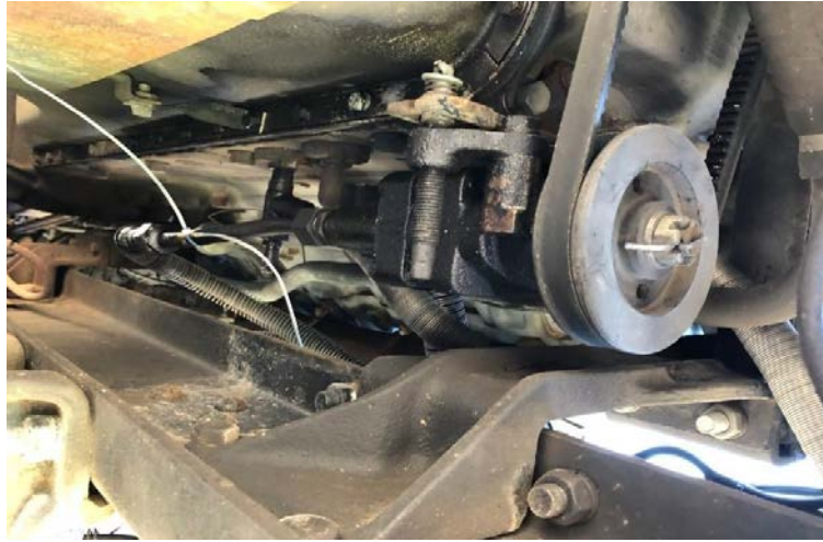
Рисунок 3.3 – Місце під'єднання термопари до трубопроводу масляного насоса
