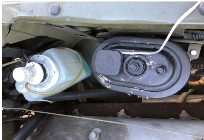
Рисунок 3.5 – Місце вимірювання температури робочої рідини в бачку насоса
