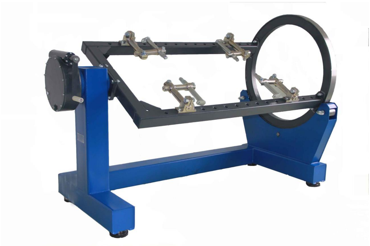
Рисунок 3.1 – Зовнішній вигляд стенду для збирання та розбирання двигунів Р776Е
