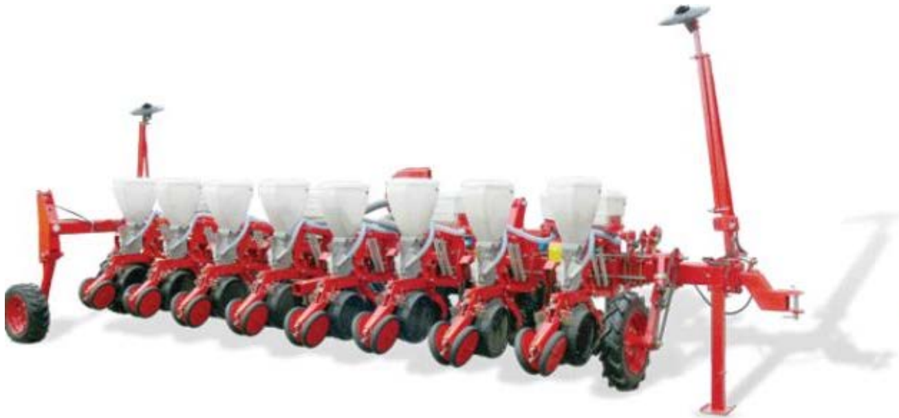
Рисунок 1.1 - Універсальні пневматичні сівалки призначені для пунктирної сівби каліброваного або відсортованого насіння кукурудзи, соняшнику, сої, рицини, сорго та інших просапних культур з одночасним внесенням в рядки окремо від насіння мінеральних добрив
