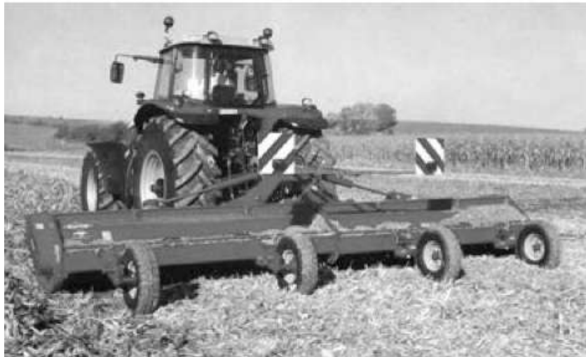
Рисунок 3.1 – Машина з горизонтальним робочим органом RM 610 фірми Kuhn (Франція) з шириною захвату 6,1 м
