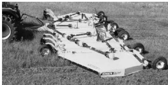
Рисунок 3.9 – Машина з вертикальними робочими органами FX 742 фірми Schulte (Канада) шириною захвату 12,8 м
