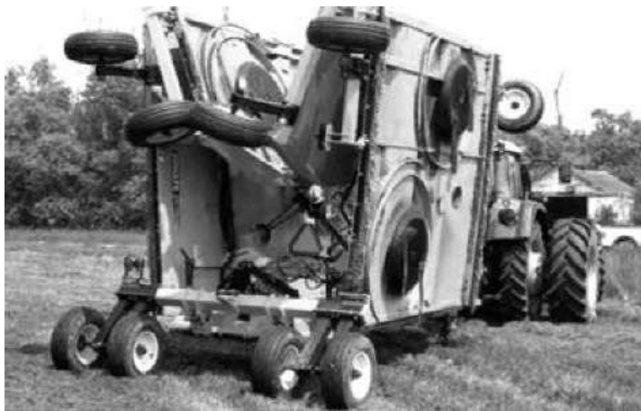
Рисунок 3.7 – Машина з вертикальними робочими органами з дисковими тримачами FX 742 фірми Schulte (Канада) шириною захвату 12,8 м (в транспортному положенні)
