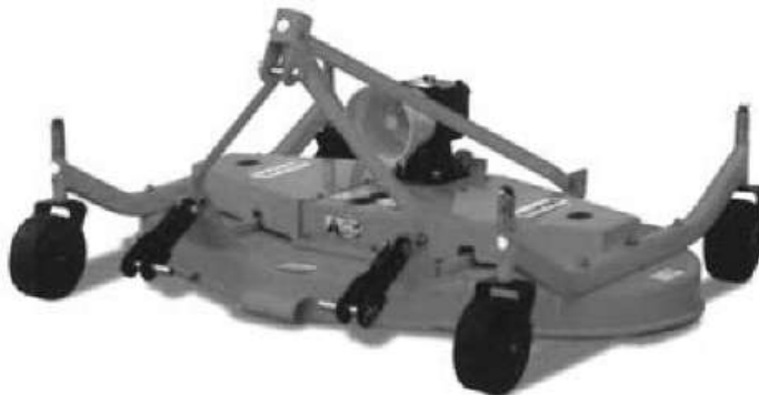
Рисунок 3.10 – Машина з вертикальними робочими органами JOLLY 120 фірми Maschio (Італія) з діаметром різального робочого органу 0,45 м і шириною захвату 1,2 м
