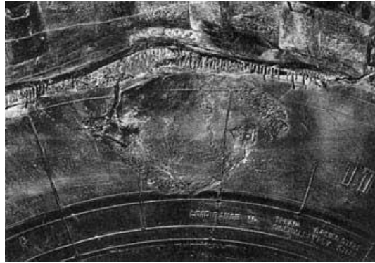
Рисунок 1.18 – Розрив каркаса внаслідок застрягання каміння між подвоєними шинами
