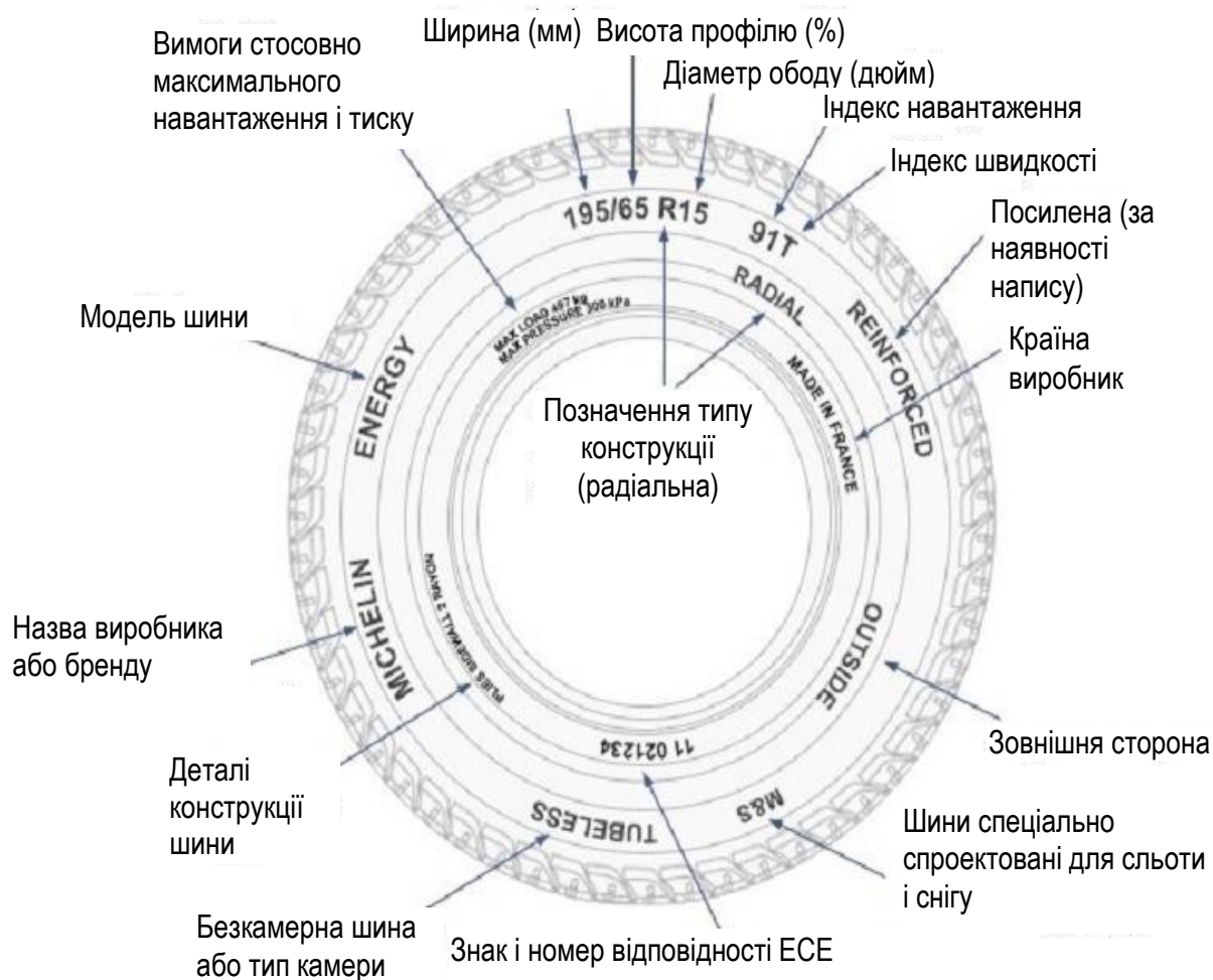
Рисунок 1.4 – Маркування шини
