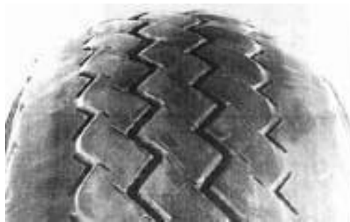
Рисунок 1.6 – Передчасне двостороннє спрацювання в плечовій зоні
