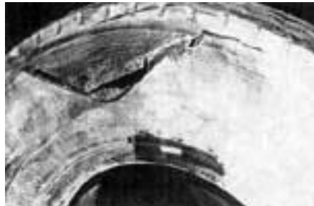
Рисунок 1.17 – Розрив каркаса від удару
