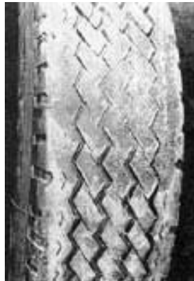
Рисунок 1.13 – Плямисте спрацювання (місцевий знос)
