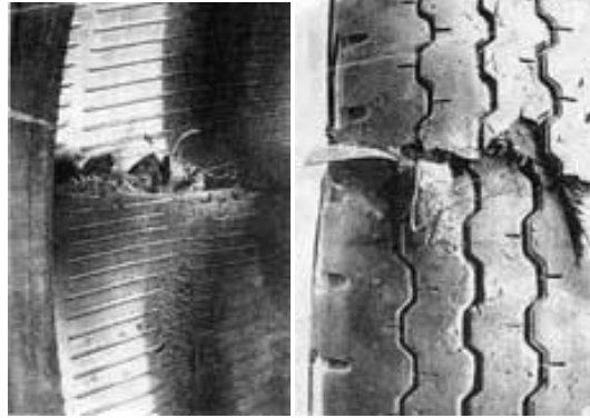
Рисунок 1.16 – Розрив протектора від удару
