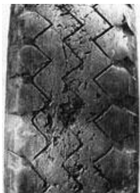
Рисунок 1.14 – Вищерблення поверхні протектора, утворення тріщин, порізів
