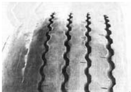
Рисунок 1.6 – Передчасне одностороннє спрацювання в плечовій зоні
