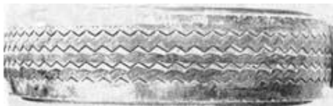
Рисунок 1.9 – Спрацювання у вигляді кілець, борозни (кругові борозенки)
